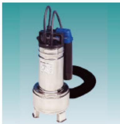
Esta chave de bóia permite a instalação da bomba onde a utilização da bóia padrão não é possível devido ao espaço disponível. A bomba com este sistema deve ser instalada somente na vertical e utilizada apenas com água limpa. Os níveis de partida e parada da bomba com este sistema são fixos não podendo, portanto, ser modificados.
